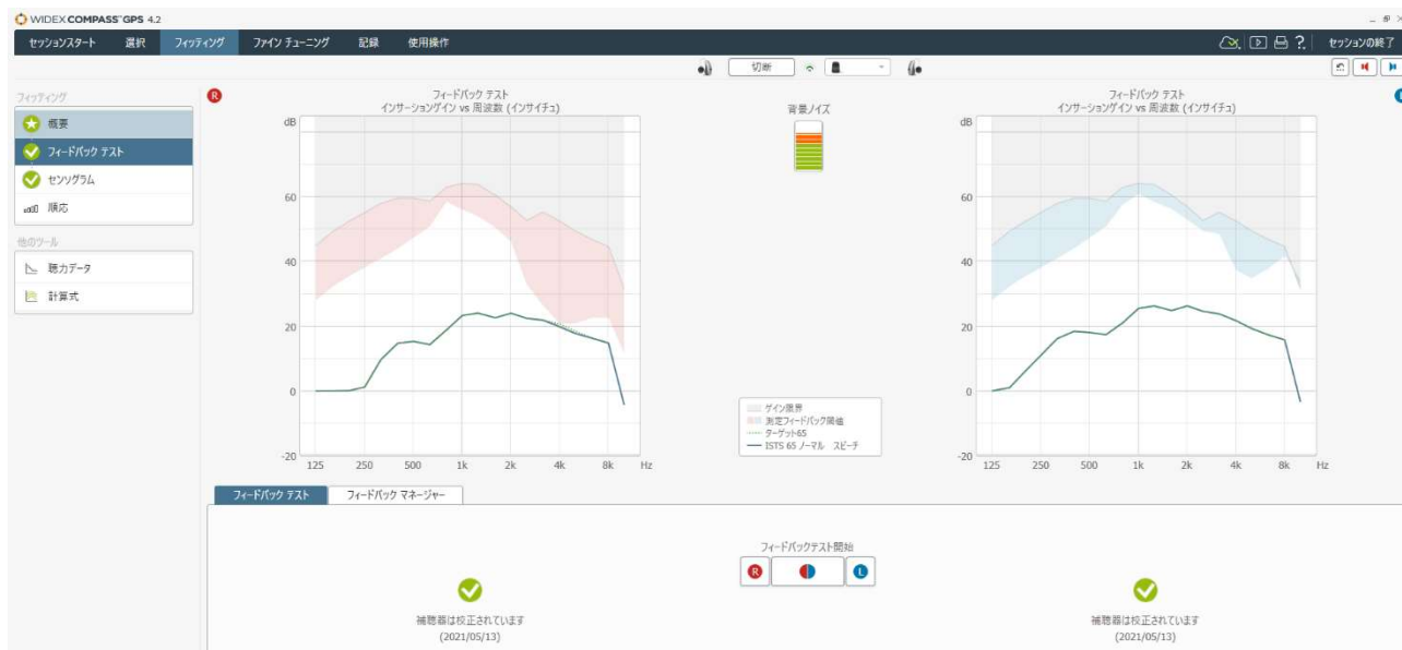
図6 フィードバックテスト：GPS 4.2では、フィードバックテストを測定するとゲイン制限のリバランスが表示されます。
