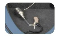
・ 測定が終わったら、補聴器をUSBlinkまたはnEARcomの 通信範囲に入れ、テストモード停止「OK」ボタンをクリックします。
