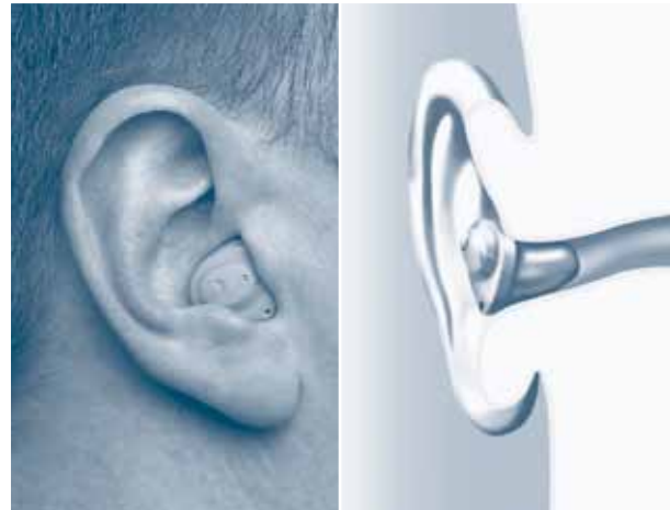
► Figur 6.02. Et i-øret-høreapparat er et individuelt udformet høreapparat, som sættes ind i øret og sidder i concha og øregangen.
