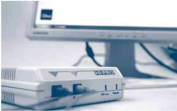
► Figur 5.08. En PC og en HI-PRO boks. Høreapparatet er tilsluttet HI-PRO boksen og kan dermed programmeres via PC'en.
