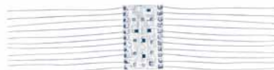
► Figur 7.15. Tyndfilmforstærker til et høreapparat. Denne forstærker fremstilles ved hjælp af en fotografisk proces.
