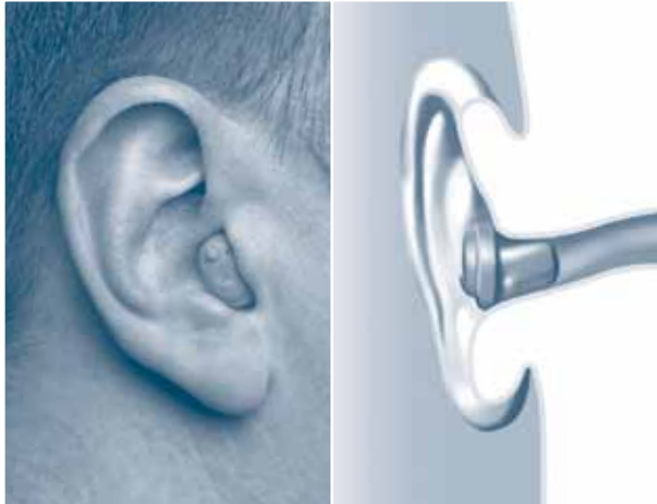
► Figur 6.03. Et kanal-høreapparat er individuelt udformet, så det passer i øregangen.
