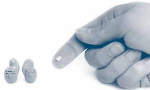
► Figur 5.12. Widex Senso i-øret-høreapparat og chip. Chippen er høreapparatets “hjerne”, da det er her, signalbehandlingen finder sted.
