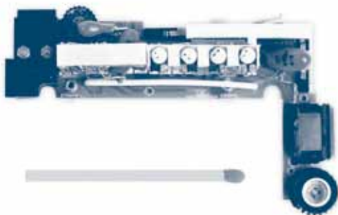
► Figur 7.14. Høreapparatforstærker fremstillet med individuelle komponenter.
