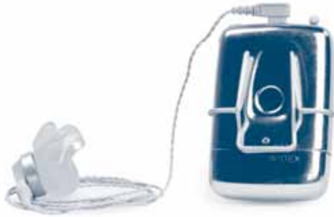
► Figur 5.03. Widex 561-lommehøreapparat fra 1956. Mikrofon, forstærker og batterier er samlet i en boks, mens en ledning leder det forstærkede signal til en højttaler, der klikkes på en individuelt tilpasset øretelefon.
