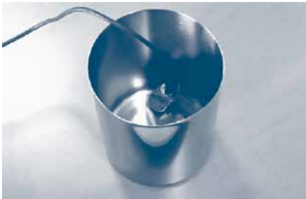
► Figur 8.25. Selvtest: Høreapparatet udsender et lydsignal, som det måler gennem sine egne mikrofoner. Ved at analysere de optagne signaler, kan eventuelle fejl opdages.
