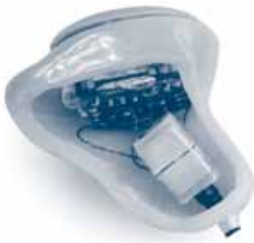
► Figur 9.14. En skal med synlig face-plate og elektronik
