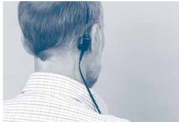
► Figur 4.06. Vibratormåling af benledningstærskler
