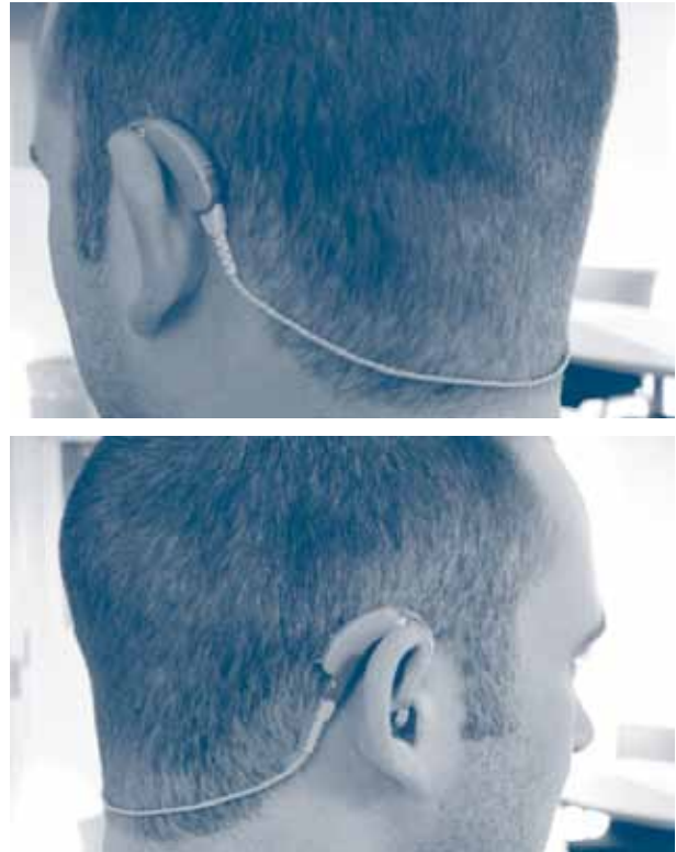
► Figur 6.07. Et BiCROS-system bruges af personer, som er næsten døve på det ene øre og har nedsat hørelse på det andet øre. Lyden fra det næsten døve øre transmitteres til det bedst hørende øre, hvor lyden forstærkes sammen med den lyd, der kommer ind i det gode øre, for at kompensere for høretabet.
