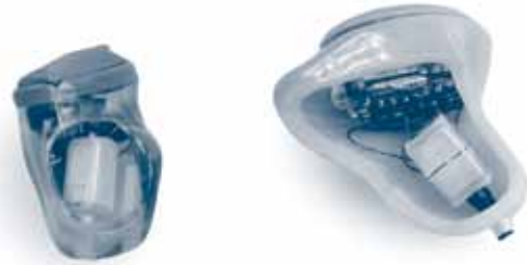
► Figur 7.04. Montering af en faceplate i et i-øret eller kanal-høreapparat.
