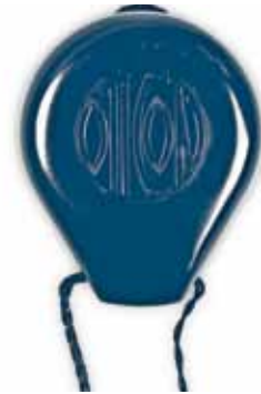
► Figur 5.02. Høreapparat med rørforstærker. To batterier leverede strøm til høreapparatet.
