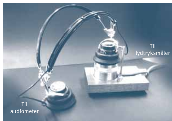
► Figur 4.18. Hovedtelefonen monteres på en kobler, og audiometeret justeres således, at 0 dB HL svarer til værdien for RETSPL ved de forskellige frekvenser. Lydtryksmåleren måler lydtrykket i kobleren.
