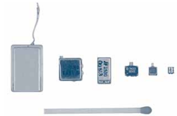
► Figur 5.01. Eksempel på, hvordan den teknologiske udvikling har haft indflydelse på størrelsen af høreapparatets komponenter. Fremskridtene inden for elektronikudviklingen har gjort det muligt at reducere mikrofonens størrelse med over 95% i forhold til 1955.
