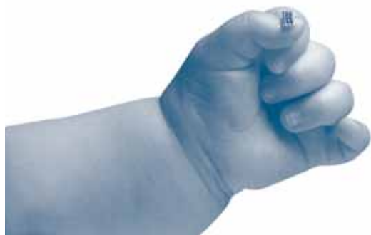
► Figur 7.13. Et integreret kredsløb (IC – Integrated Circuit), som anvendes i et Widex Senso CIC-model, er meget lille.
