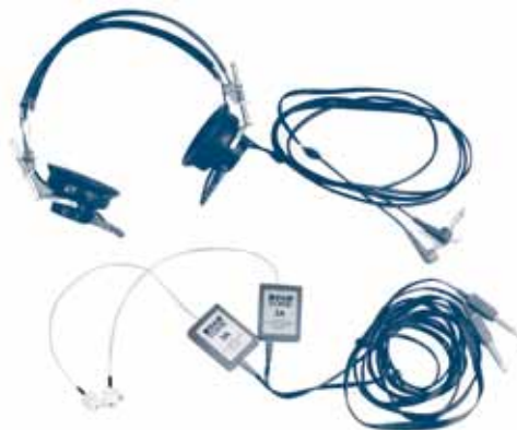
► Figur 4.04. Der findes forskellige typer hovedtelefoner til at måle luftledningstærskler: hovedtelefoner, som sættes uden på øret (øverst), eller indstikstelefoner (nederst), som indsættes direkte i øregangen.
