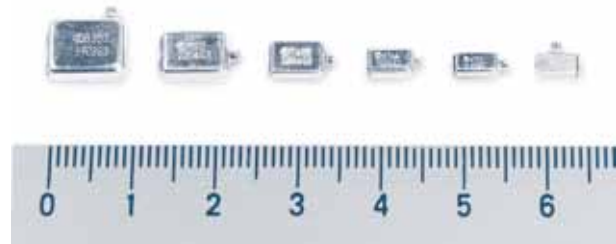
► Figur 7.21. En række højttalere til høreapparater på en lineal. Jo større højttaler, desto højere maksimalt outputniveau.
