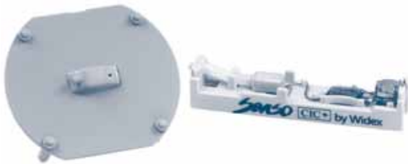
► Figur 7.03. Hvad angår i-øret- og kanalhøreapparater, leveres en faceplate, som indeholder høreapparatets elektronik til montering direkte i skallen. Elektronikken til CIC-høreapparater leveres på en monteringsskinne.
